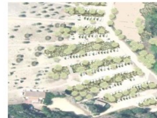
Exemple de parking en milieu naturel Modules de stationnement à sens unique, avec entrée et sortie distinctes. Surfaces de stationnement en tuf stabilisé, entrecoupées de noues paysagères plantées d'arbres et d'arbustes locaux. (MHS Paysagiste)
